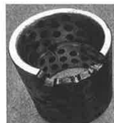
非純正カートリッジグリースを使用してしまった事で早期破損してしまったボールねじとブッシュ
