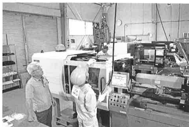
金型取付け作業
