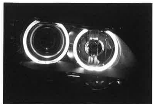
図5 LCグレードの採用事例（自動車導光リング）
