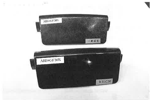
手前がヒート&クールシステムで成形した製品
