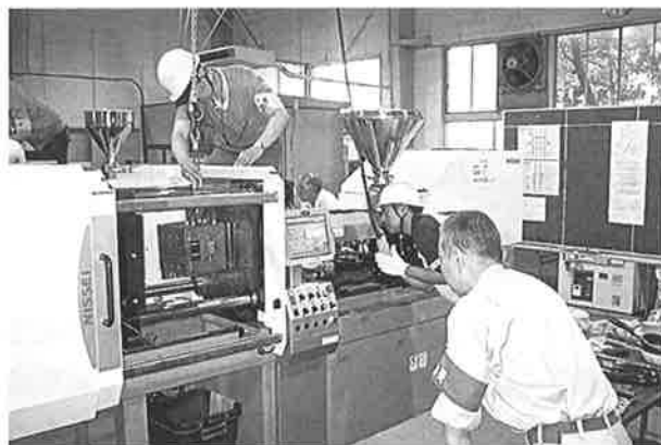
金型取付け作業
