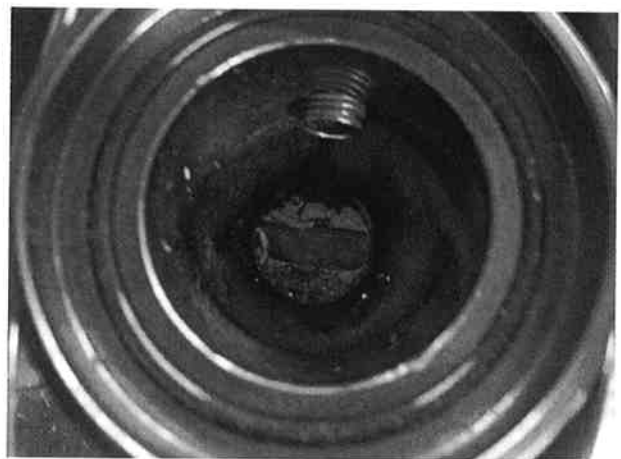
ベント内の樹脂
